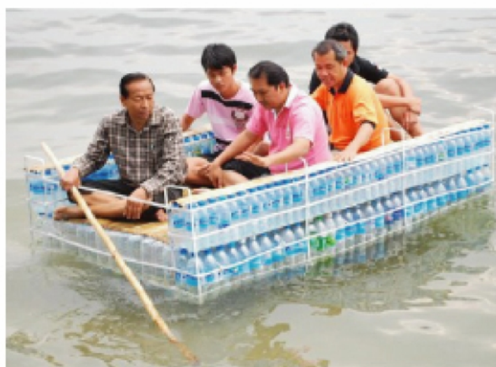
Construye un bote con botellas plasticas; Dato curioso: utiliza un poco de hielo seco en cada botella antes de tajarla para que el plastico se tense dando mayor resistencia y flotabilidad
