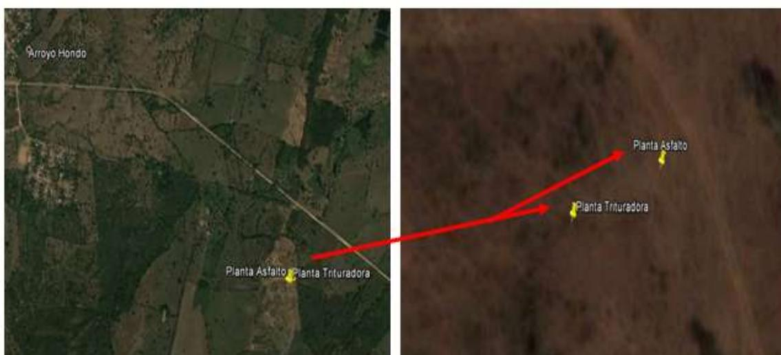
Se instalará (2) dos plantas móviles, una (1) planta asfáltica y una (1) planta de clasificación y trituración de materiales pétreos, con la finalidad de obtener el producto ideal para su respectivo uso. A continuación se detallan las características técnicas, de dichas plantas.
