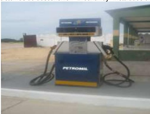
**Foto No 2. Dispensador con dos mangueras electrónicas para Suministro de combustible**
