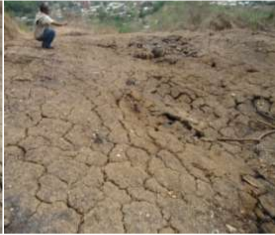
Foto 5. Agrietamiento suelo del relleno por quema de residuos sólidos dispuestos en el relleno.
