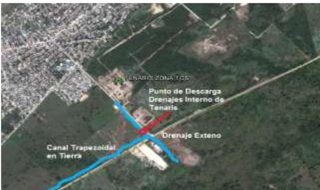
Los drenajes internos del predio de Tenaris fueron divididos en 5 subcuencas identificadas como A1b, A2b, A3b, A4b y A5b. (Como se muestra en la Figura). Los cauces definidos en el predio de Tenaris pueden ser manejados y conducidos a través de canales internos hasta el punto de descarga ubicado en la parte sur del lote en donde se encuentra un canal trapezoidal en tierra paralelo a la Variante Mamonal – Gambote.
