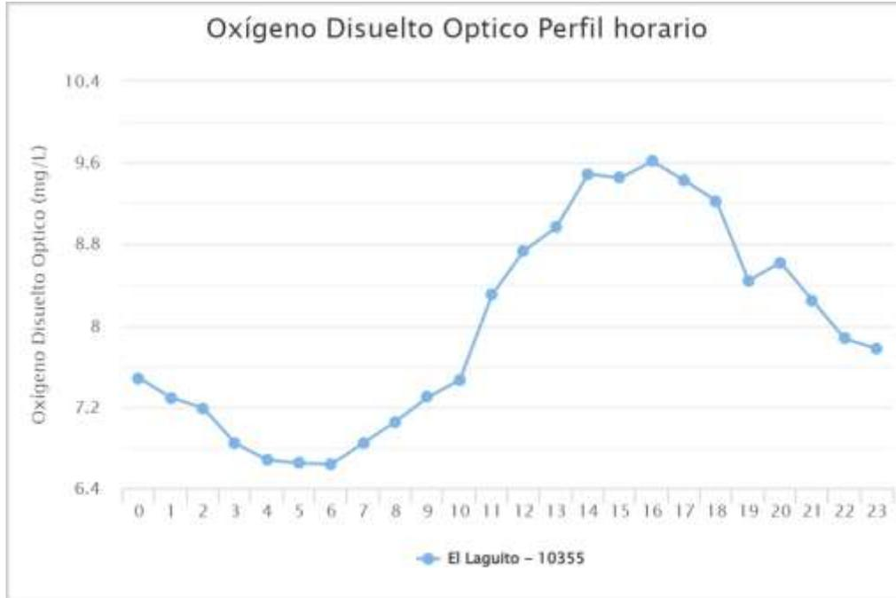
Ilustración 6. Perfil horario de Oxígeno Disuelto Agosto estación AG4-El Laguito
