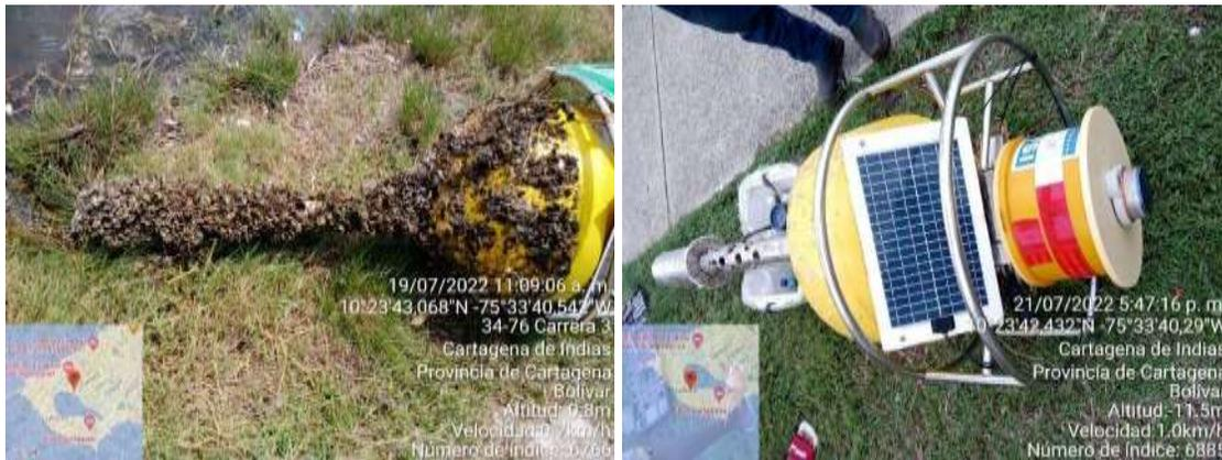
Ilustración 18. Evidencia fotográfica antes y después de limpieza realizada en boya El laguito.
