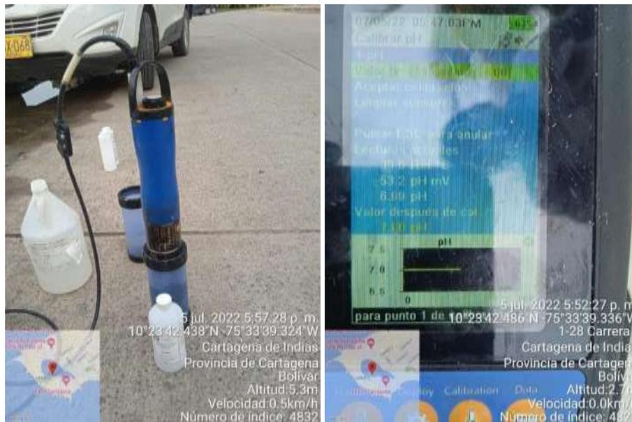
Ilustración 16. Evidencia fotográfica de verificación sonda.
