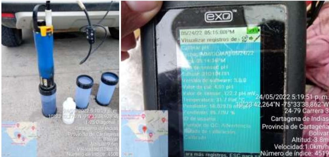
Ilustración 13. Evidencia fotográfica de la calibración de la sonda de calidad de agua en el Laguito.
