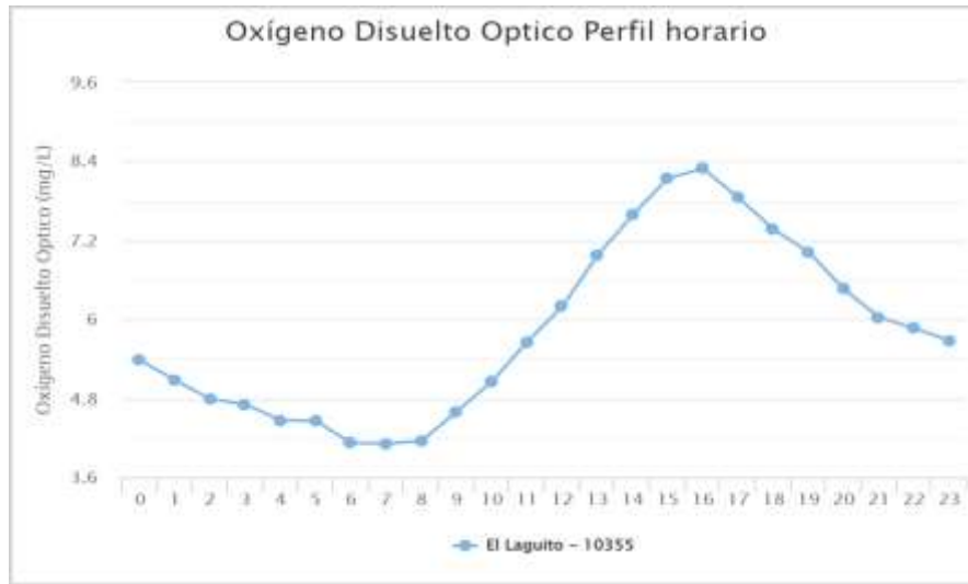
Ilustración 6. Perfil horario de Oxígeno Disuelto Abril estación AG4-El Laguito Fuente: Estudio Actual
